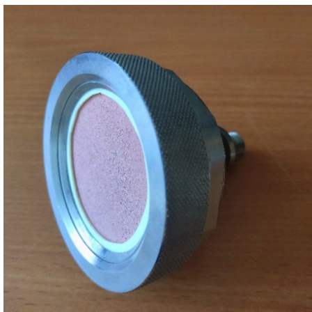
Рис. 4. Керамический диспергатор со ср. значением диаметра пор 180 мкм
